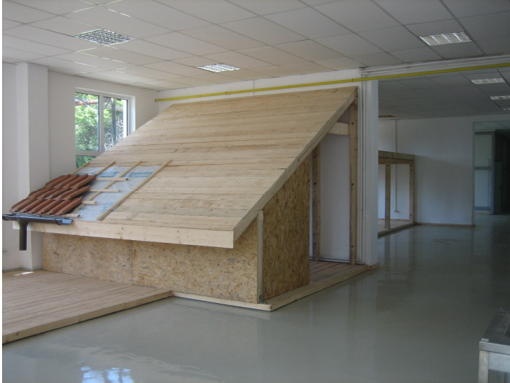
Banc de training “Sisteme de izolare pentru acoperiș”.
