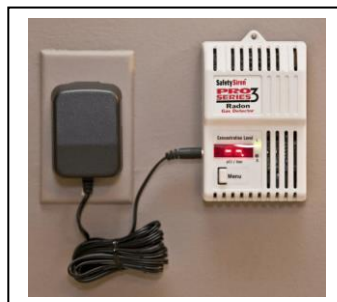
Fig. 28 – Detector, sistem de procesare si alarmare pentru monitorizarea concentratiei de radon
