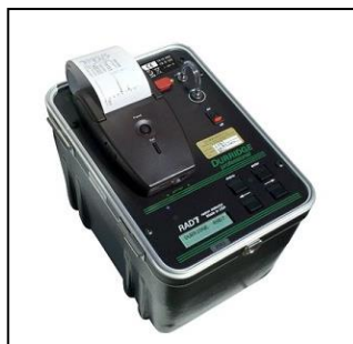
Fig. 29- Detector de radon cu imprimanta pentru tipărirea buletinului de masuratori
