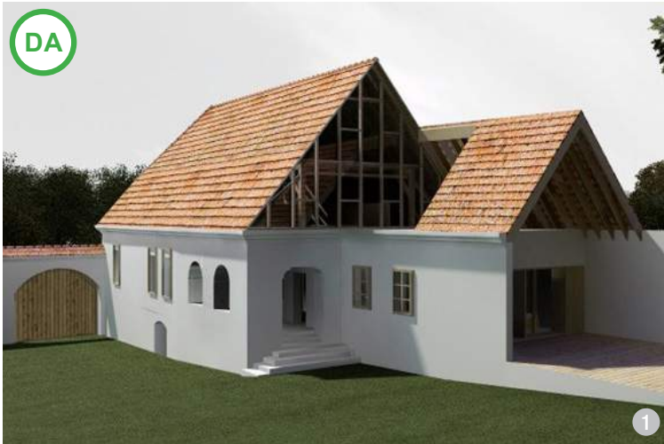
AȘA DA: Intervenție posibilă pentru clădiri tradiționale cu valoare arhitecturală. S-a reușit amenajarea unei terase circulabile fără să se modifice consistent imaginea de ansamblu a acoperișului. (Copșa Mare, jud. Sibiu)
