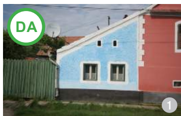
Acoperiș într-o singură apă, specific preponderent pentru zona Târnavelor și pe Valea Hârtibaciului. (Vecerd, jud. Sibiu)
