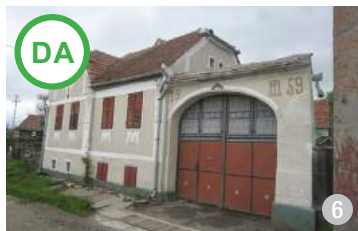
Acoperiș în patru ape cu rupere de volum, specific atât caselor săsești, cât și celor românești de pe Târnavă, de pe Valea Hârtibaciului și de la limita cu Țara Oltului. (Ighișu Vechi, jud. Sibiu)
